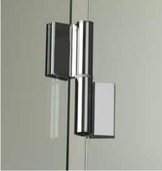
Hidrolik kapı kapatıcıların evrimi ve sentezi niteliğinde olan yenilikçi EVO hidrolik menteşe , iç ve dış mekânlardaki kontrollü kapanış istenen cam kapılar için en ideal çözümü sunmaktadır. Evo Hidrolik menteşenin cam cama versiyonunun yanı sıra , cam duvar modeli de mevcut olup 1.000.000 kez açma kapama için test edilmiştir. Alman TUV sertifikasına sahip olan ürün , 120kg taşıma kapasitesine sahiptir.
